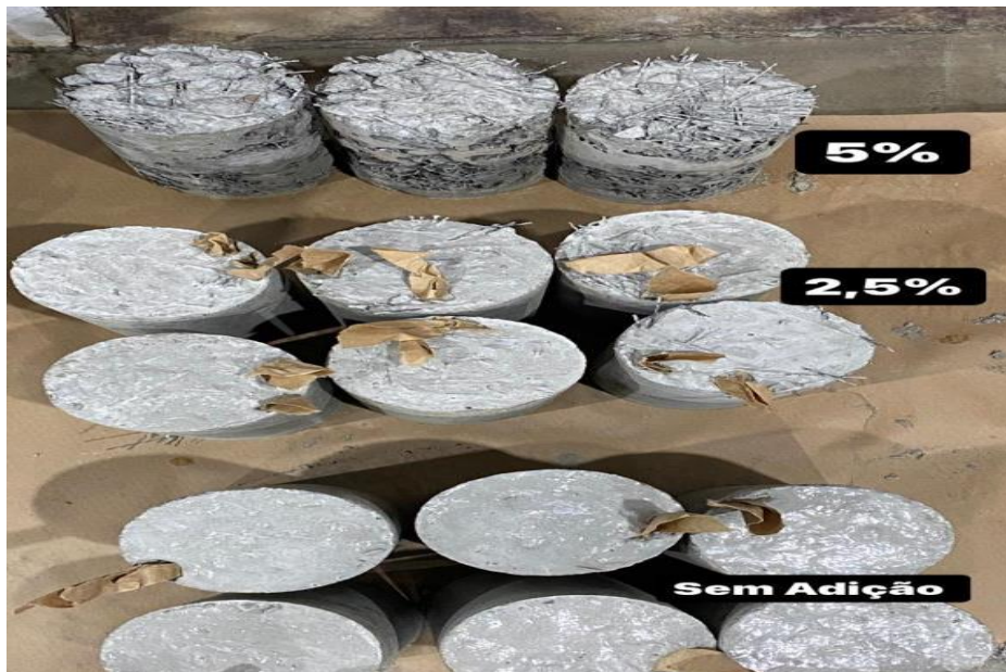
Figura 09 – Amostras desenformadas e separadas.
