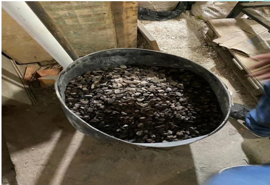
Figura 02 – Pesagem dos agregados (Brita)
