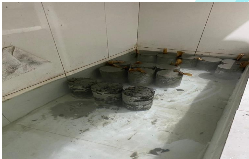
Figura 10 – Amostras submersas, em processo de cura.
