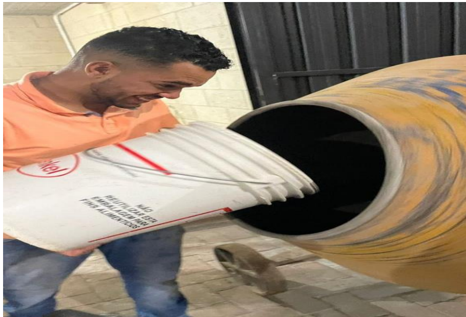
Figura 06 – Adição das fibras de polipropileno à composição.
