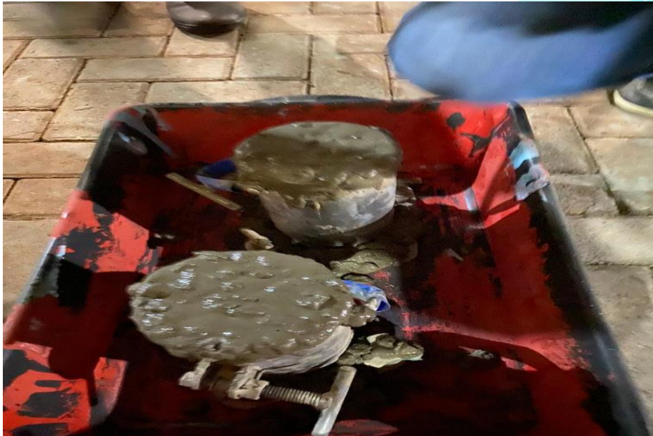
Figura 08 – Modelagem dos corpos de provas.
