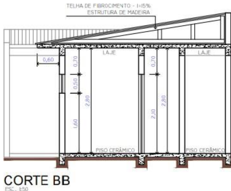
Figura 8 - Projeto estrutura de madeira.
