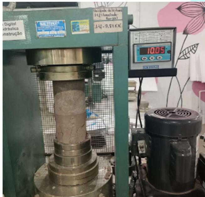
Figura 9 – Teste de resistência com adição. Fonte: Autoria Própria (2023).
