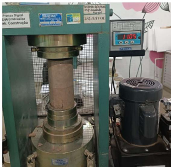
**Figura 6 - Teste de resistência com adição de solo argiloso. Fonte: Autoria Própria (2023).**
