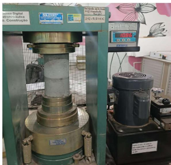
**Figura 7 - Teste de resistência do concreto convencional. Fonte: Autoria Própria (2023).**
