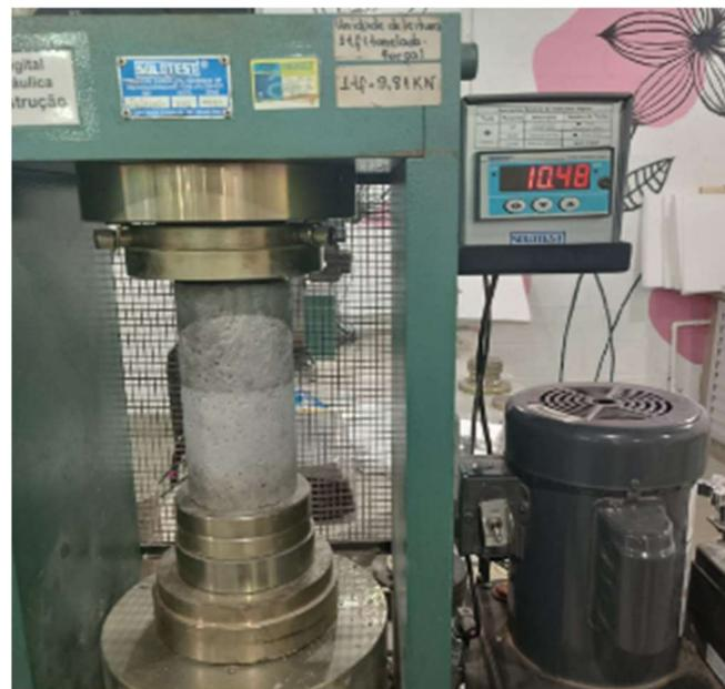
Figura 10 - Teste de resistência do concreto convencional. Fonte: Autoria Própria (2023).
