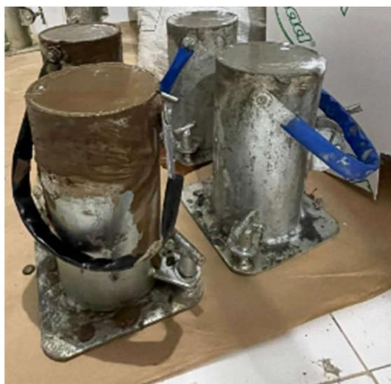
Figura 5 - Corpos de prova na câmara úmida. Fonte: Autoria Própria (2023).
