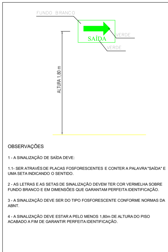
DETALHE 01 - SINALIZAÇÃO SAÍDAS DE EMERGÊNCIA
